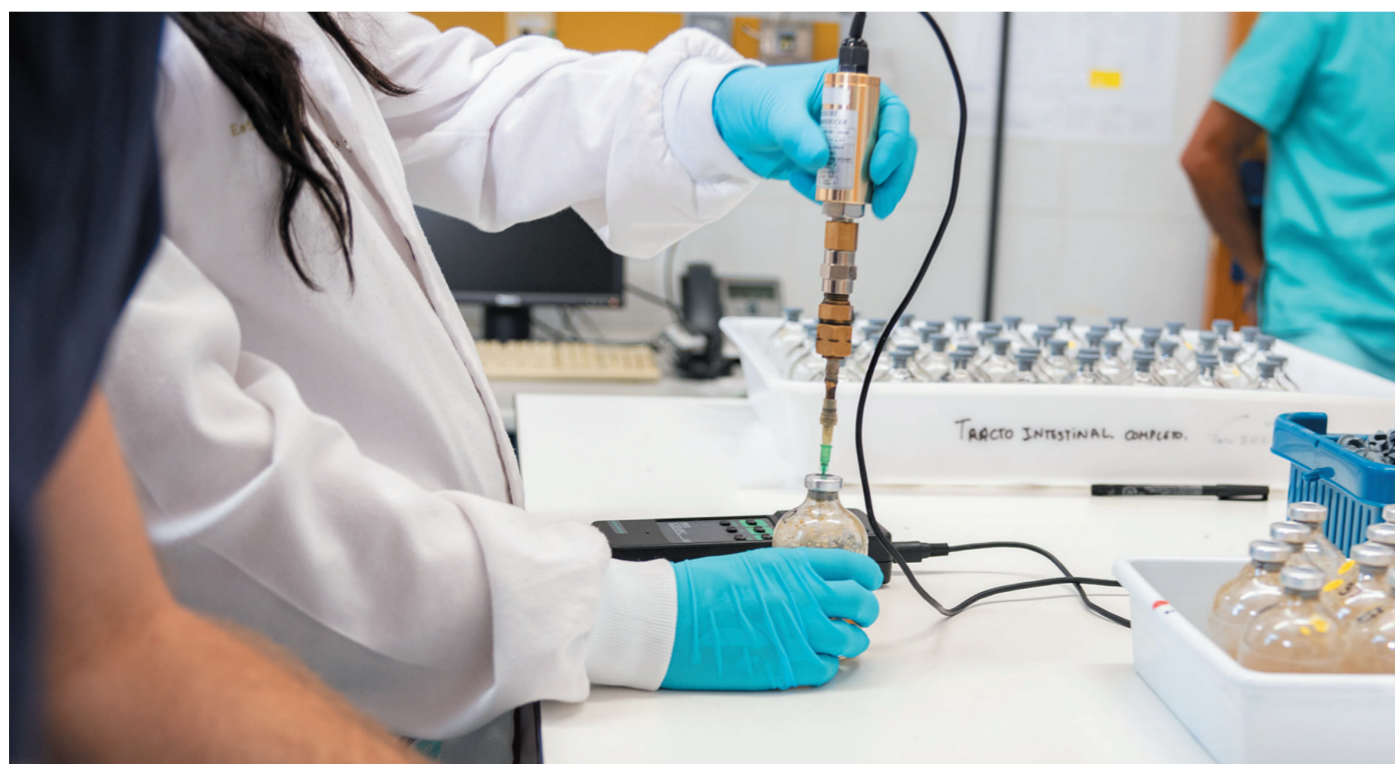
Figura 1. Lectura de presión del gas en espacio libre por técnica de laboratorio.
